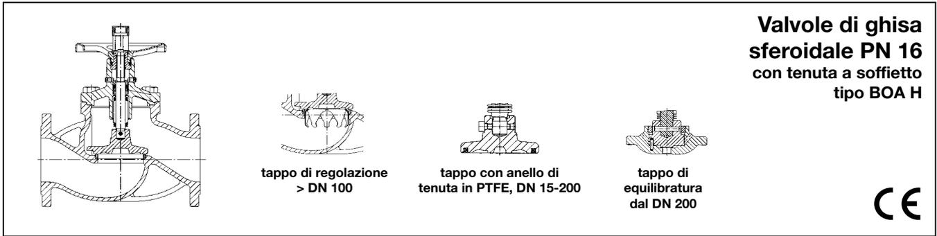
**Valvole di ghisa sferoidale PN 16 con tenuta a soffietto tipo BOA H**
